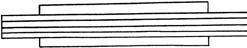
图 2 试样叠装状态示意图
